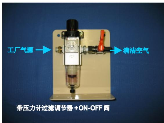
主轴部冷却空气以及夹持机构部均使用清洁空气。
