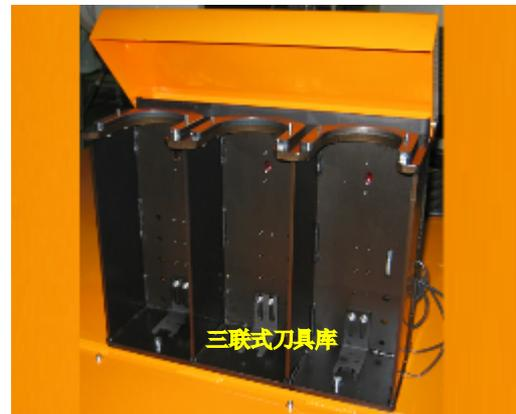
3 连式刀具库为标准型，如有需要可增设 6 连式、9 连式。带有落座传感器 + 气缸
