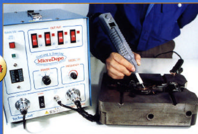
利用“MicroDepo”机型100模具进行沉积堆焊
