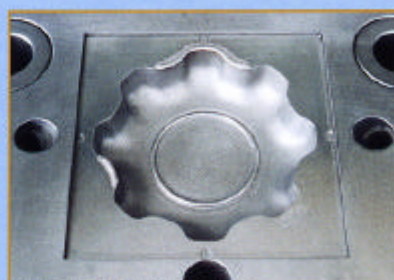
工件: 塑料成形用模具(凹部整体皱纹) 问题: 产品上发生针刺(如果进行TIG焊接将影响到皱纹部) 处理: 沉积堆焊(由于不会产生热影响也不会使皱纹部发生问题) 材质: NAK 电极: SD-01
