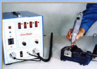
工件: 模锻机模具 问题: 管材的光滑度 处理: 被覆 材质: SK 电极: WC-Co 表面光洁度: 差
